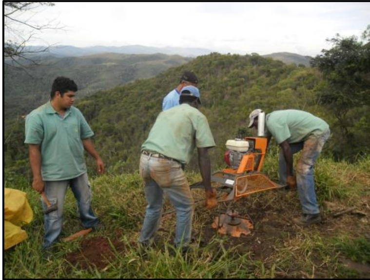
Figura 11: Equipe de sondagem, realizando a perfilagem. Fonte: GEPI, 2012.
