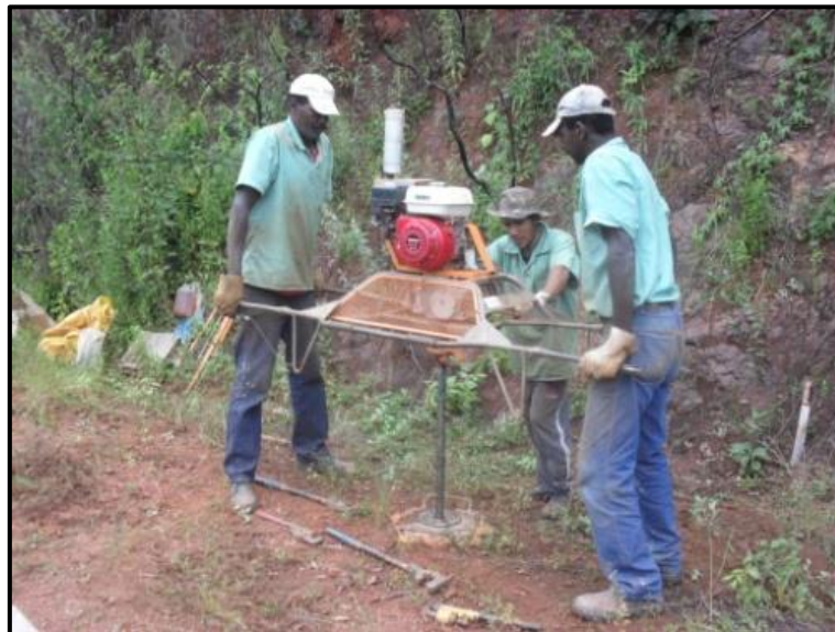
Figura 10: Equipe de sondagem, realizando a perfilagem a trado. Fonte: GEPI, 2012.
